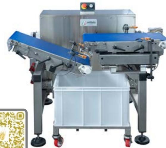
Il nostro sistema di controllo peso automatico permette di automatizzare in modo veloce e sicuro, grazie alla espulsione automatica, il peso di qualsiasi prodotto, incartato o meno.
