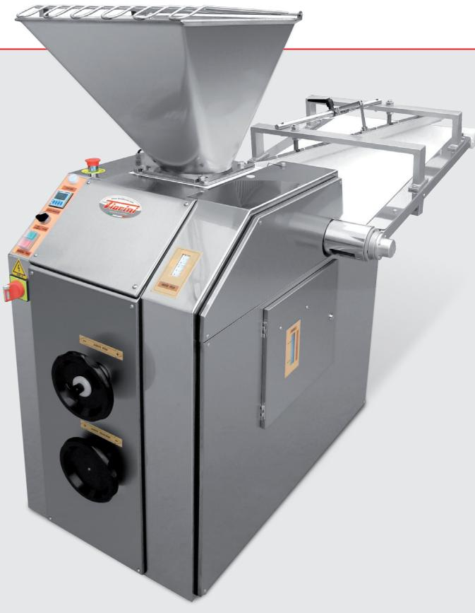
L'impasto è assorbito da un pistone, pressato e poi espulso. Questo sistema consente una buona precisione di pesatura e di non maltrattare l'impasto.
