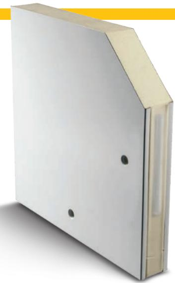
Tipo sandwich con 2 supporti metallici con interposta schiuma di poliuretano (PUR) rigida. Lamiera zincata preverniciata 30 microns, colore bianco RAL 9010, atossica, con pellicola protettiva temporanea.
